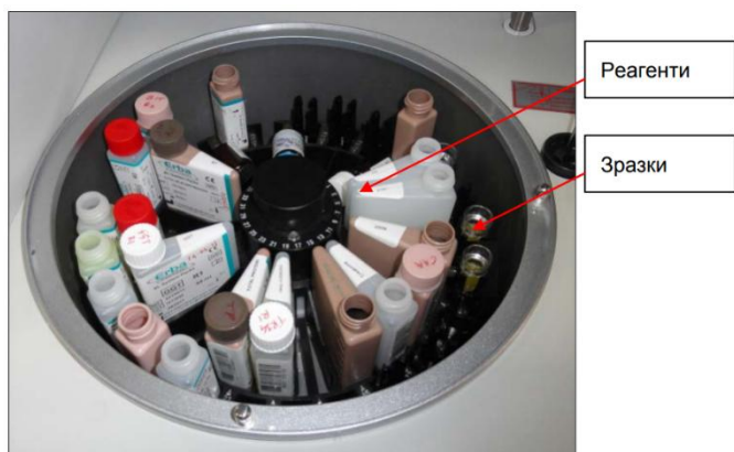
Рис.11 Зовнішній вигляд диска зразків та реагентів
