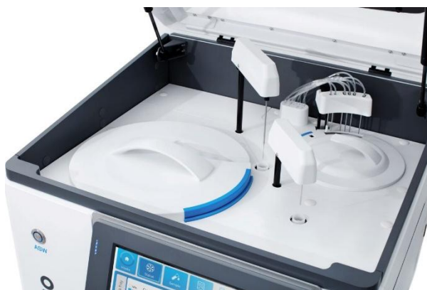
Рис.13 Зовнішній вигляд приладу (диск зразків та реагентів, диск реакції, миюча станція, міксер, голка)
